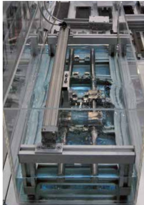
Lebensdauer- und Verschleißversuch einer drylin®-Linearführung im "Unter-Wasser-Becken".
