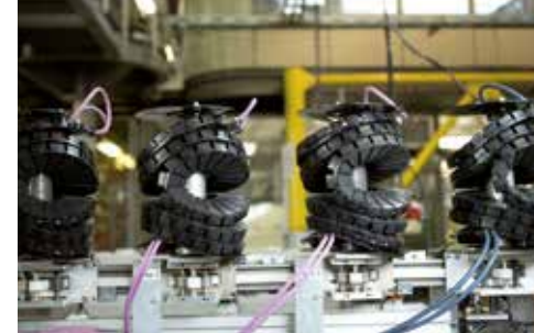
Test auf Torsion und Verdrehung mit e-ketten® und chainflex®-Leitungen.
