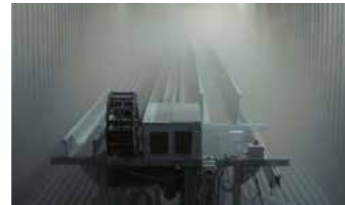
Kältetest bei -40°C von chainflex®-Leitungen und e-ketten®.
