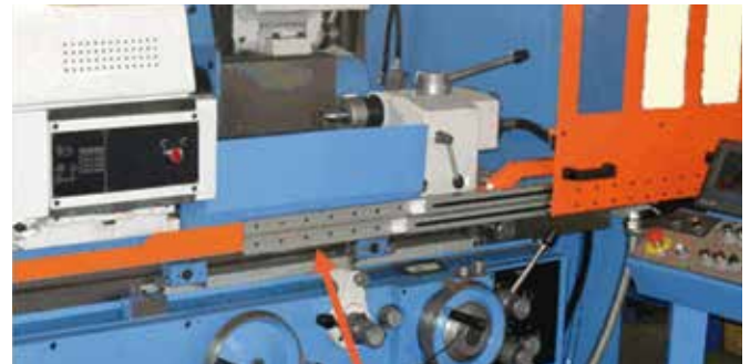
drylin® NT LM in Schutztürverstellung in Werkzeugmaschine
