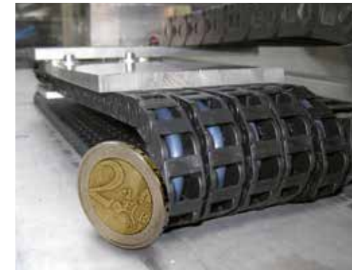
Steuerleitung CF98.05.04 getestet in e-kette®. Mehr als 138 Mio. Hübe bei einem Biegefaktor von 3,2 x d
