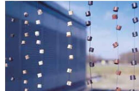
iglidur® Gleitlager im UV-Langzeittest
