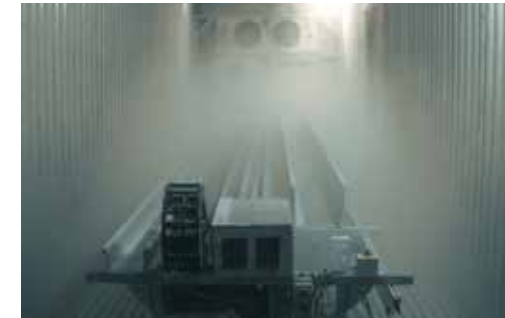
Kältetest in der Klimakammer bei -40°C
