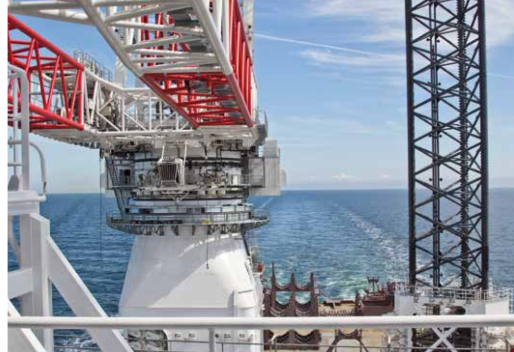
Schiffskran zum Aufstellen von Offshore-Windanlagen. igus® e-ketten® und chainflex® Leitungen realisieren die Energieversorgung für die Drehbewegung des Krans
