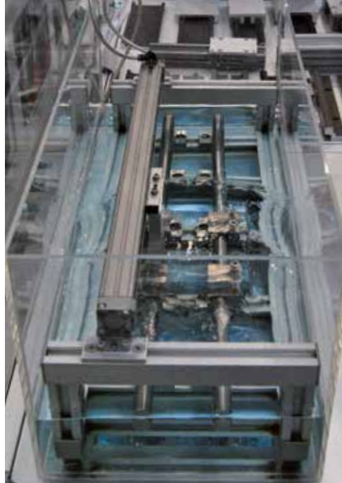
Lebensdauer- und Verschleißversuch einer drylin ® -Linearführung im "Unter-Wasser-Becken".
