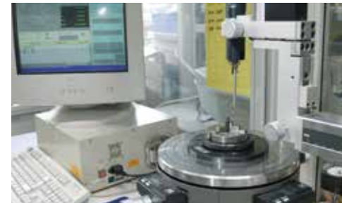
Messung des Innendurchmessers eines eingepressten Gleitlagers.
