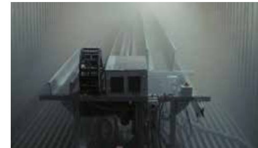
Kältetest bei -40°C von chainflex ® -Leitungen und e-ketten ® .
