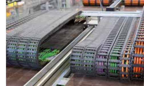
Lebensdauerversuche e-ketten ® und chainflex ® -Leitungen.
