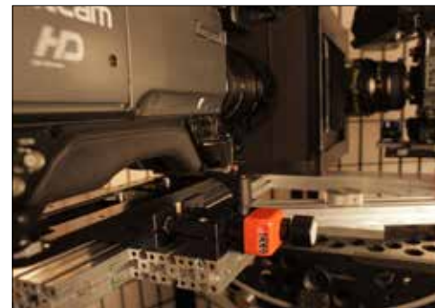
drylin® SHT-"Komplettpaket" mit Lineartisch, Klemmung, Positionsanzeiger und Handrad ermöglicht die punktgenaue Positionierung von 3D-Filmkameras. [ECC Stutenbäumer KG]
