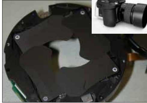
Dieser Verschluss für Fotokameras funktioniert absolut präzise und innerhalb von nur 1,5 ms. Hierfür sorgen iglidur®-Gleitlager. [Viktor Hasselblad AB]
