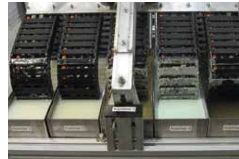
Beständigkeitsprüfung in verschiedenen Ölen und Flüssigkeiten
