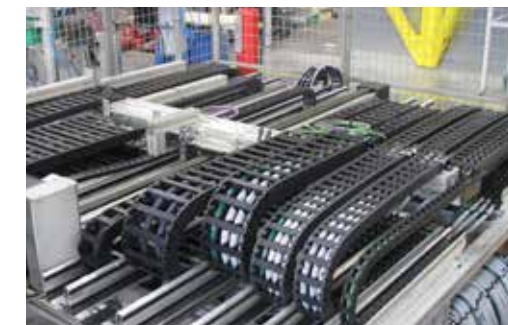
Dauerbewegungsversuche mit definierten Biegeradien
