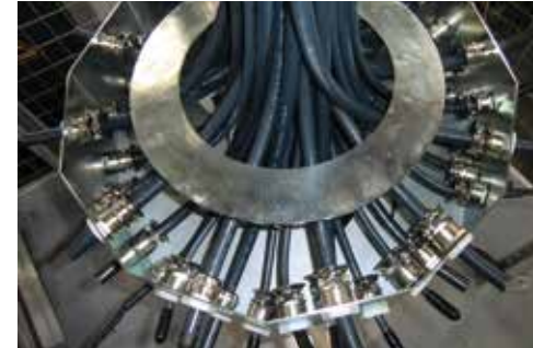
Beanspruchung der chainflex® Leitungen auf Torsion
