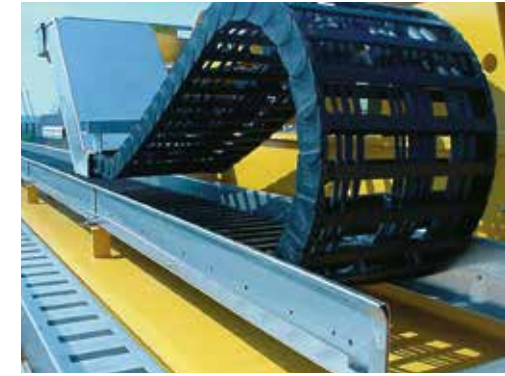
Sehr langer Verfahrweg an einem Kran, sicher geführt in igus®-Rinnensystemen
