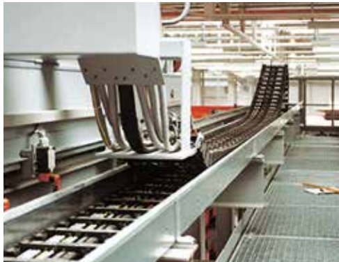
e-kettensystem® E4 auf langem Verfahrweg in einer Stahl-Führungsrinne
