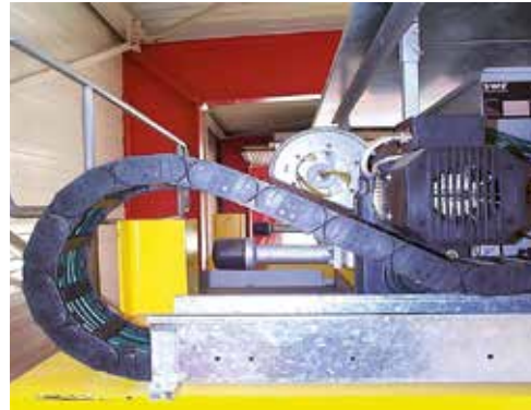
e-kettensystem® am Ende des Kranträgers
