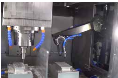
robolink® D – Suction arm in a machine tool robolink® D – Saugarm in einer Werkzeugmaschine (igus® GmbH)
